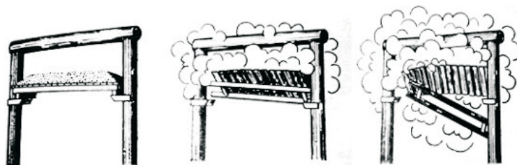
Rys. 2. Przebieg uruchamiania zapory z pyłem kamiennym (Cybulski 1973)
