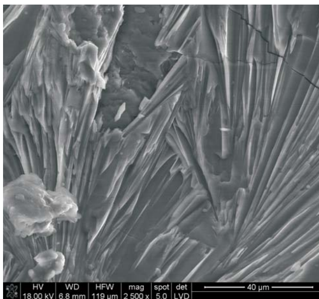
Fot. 3. Obraz SEM piaskowca godulskiego ze złoża Tokarzędka.
