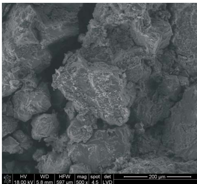
Fot. 8. Obraz SEM piaskowca istebniańskiego ze złoża Sobolów. Przestrzeń porowa po usunięciu kryształów tenardytu w wyniku przepłukania piaskowca wodą
