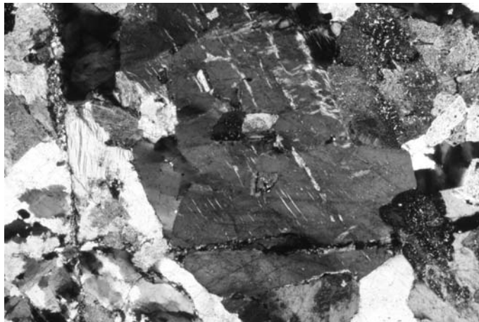
Rys. 3. Leucogranit ze złoża Pagórki Zachodnie. Mikroperyty o różnej genezie (pierwotne i wtórne) w otoczeniu zsercytyzowanych plagioklazów (po prawej) i kwarcu (po lewej). PX
