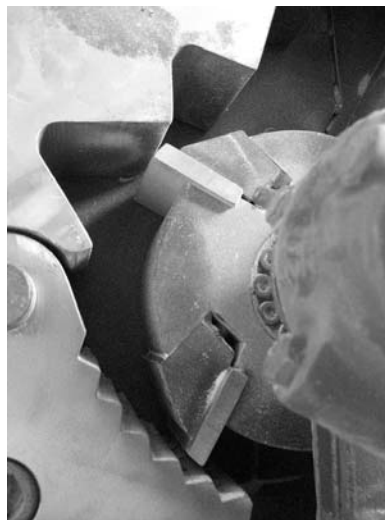
Rys. 3. Elementy robocze kruszarki (fot. T. Gawenda)
