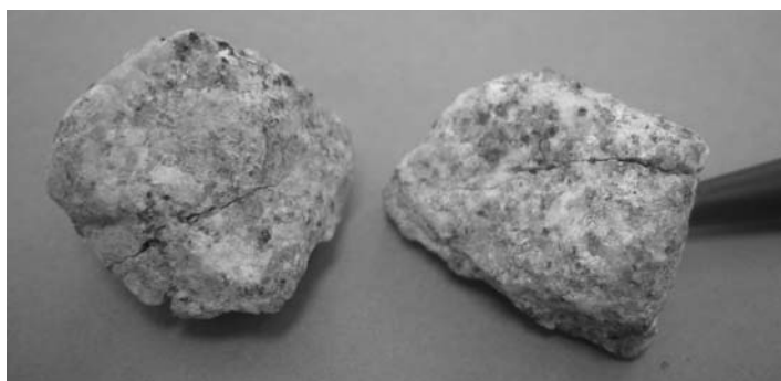
Rys. 10. Pęknięte ziarna kruszywa granitowego uzyskane w kruszarce szczękowej (fot. M. Lugmayr)
