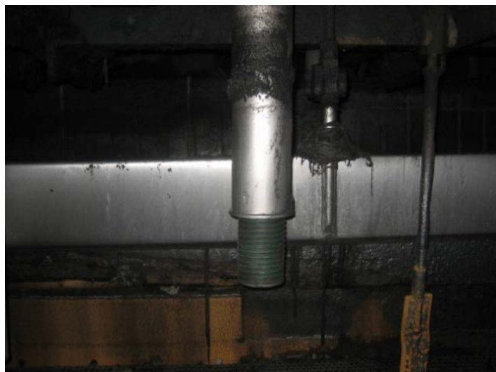
Rys. 6. Widok sondy miernika promieniowania naturalnego
